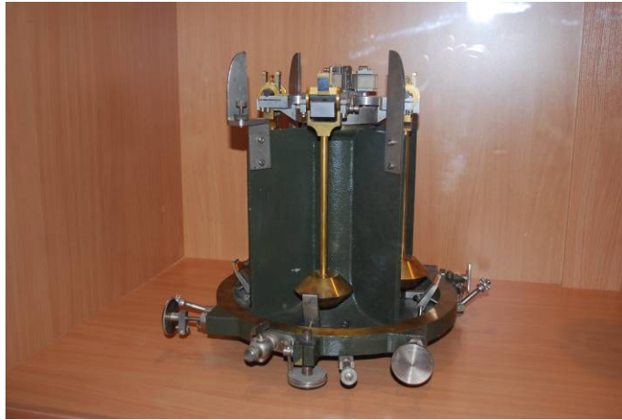
Özbekistan Bilimler Akademisi Astronomi Enstitüsü'nde sergilenen bir yerçekimi ivmesi ölçüm aleti
